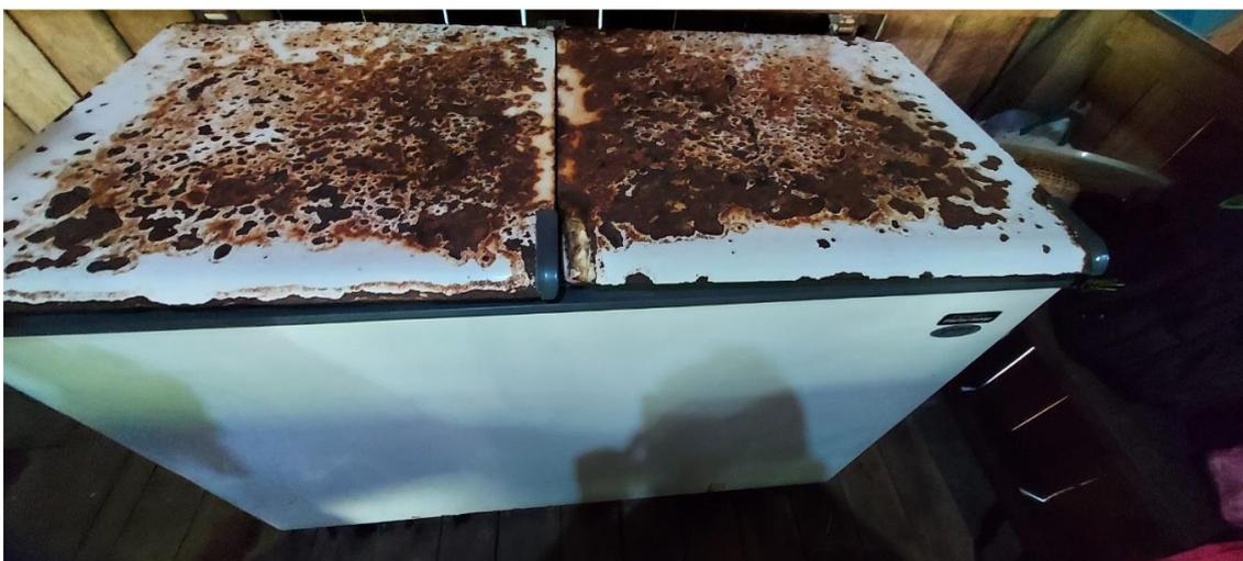
**Figura 4 CAOTEC/ GATI: Freezer com excesso de oxidação**
